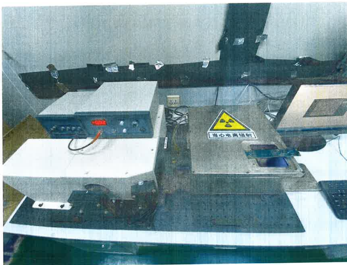
GGAG 闪烁陶瓷 X 射线辐照衰减实验
